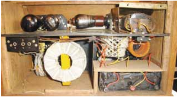
Van der Meer-Broodje met verwijderde bovenklep en achterwand, vanaf achterzijde gezien. Rechts onder de 21 volt negatieve rooster-spanningsbatterij, daarboven 1 e afstemkring (C1). Linksonder de 2 e afstemkring (C2) met terugkoppeling. Daarachter de kleine variabele condensator (C3) voor fijnregeling van de terugkoppeling. Middenonder naar boven lopend en dan horizontaal en over de voedingstrafo, een koperen plaat ter afscherming van hoogfrequent stoorvelden.
