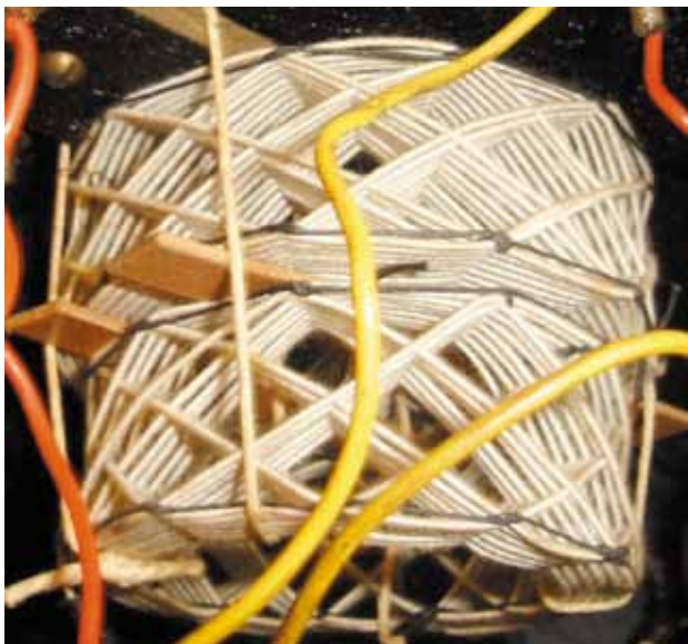
Spoelen welke door de golfbereikschakelaar (S1-S2) worden ingezet. De spoelen werden met touwtjes mechanisch aan elkaar gebonden en met beugels aan de behuizing bevestigd. Het is het tegenovergestelde van wat men in de regel met een "houtje-touwtje-constructie" bedoelt, de constructie is zeer solide en na 83 jaar nog steeds in perfecte staat!
